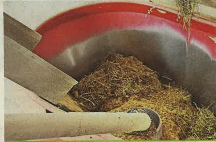
Le bol mélangeur du Vector prépare régulièrement une ration et la distribue de façon autonome.
