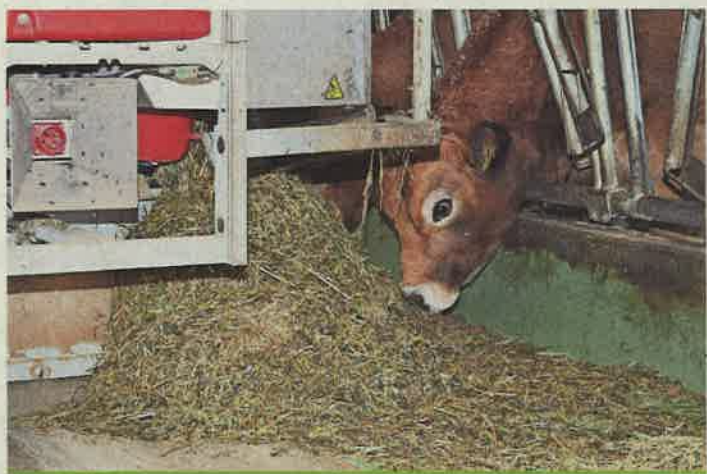
Régulièrement, le robot pousse le fourrage et mesure les restes dans la crèche. Si besoin, il prépare et distribue automatiquement une nouvelle ration.
